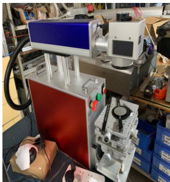
Hình 2.7. Ảnh chụp hệ khắc laser được sử dụng để khắc tạo hình Cấu trúc micro trạng màng được nghiên cứu chế tạo trong Luận án này.
