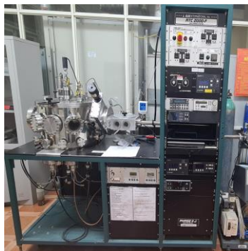
Hình 2.6. Hệ phun xạ ATC-2000F tại Phòng Thí nghiệm Trọng điểm công nghệ micro - nano, Trường ĐHCN
