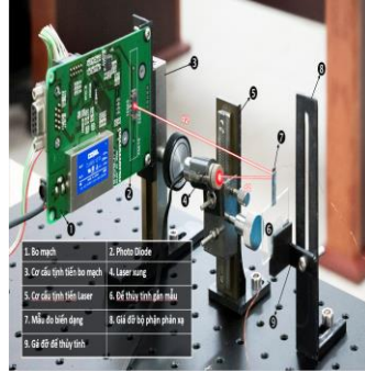
Hình 2.11. Ảnh thực tế hệ đo strain tự xây dựng tại Phòng Thí nghiệm VMINATEC.
