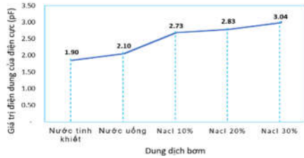
Hình 3.22. Giá trị điện dung đo được ứng với các chất lỏng bơm khác nhau NaCl 20%
